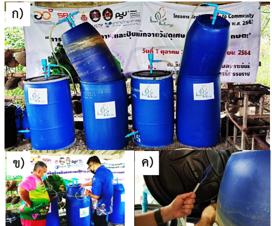
รูปที่ 5 (ก) ก๊าซชีวภาพวันที่ 15 (ข) เก็บตัวอย่างก๊าซวิเคราะห์ด้วย GC-TCD (ค) การทดสอบก๊าซจุดติดไฟ
