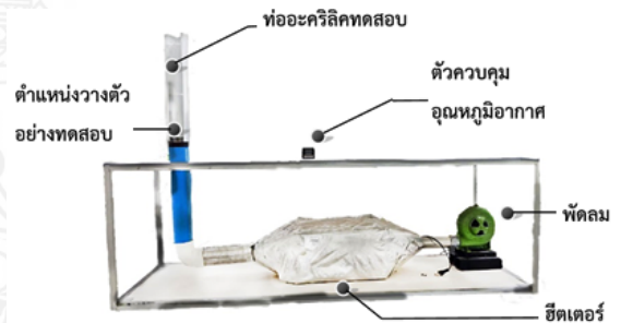
รูปที่ 5 การทดสอบหาค่าความเร็วสุดท้ายและสัมประสิทธิ์ต้านทานการไหลของเมล็ดข้าวเปลือก
