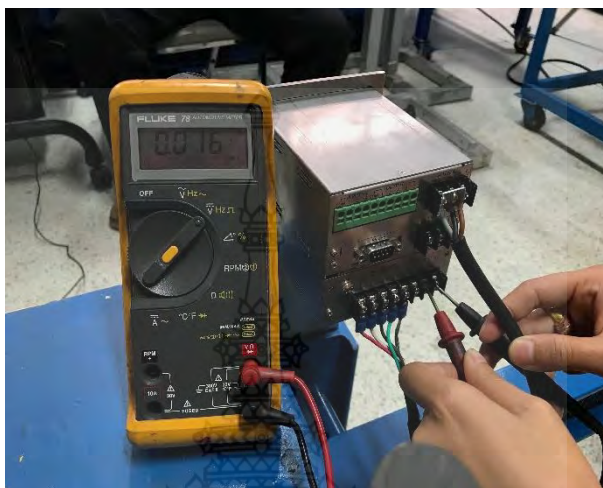
รูปที่ 3.11 วัดกระแสไฟโดยใช้มัลติมิเตอร์
