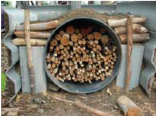
รูปที่ 4 ลักษณะการเรียงไม้ในเตาเผาถ่าน 200 ลิตร
