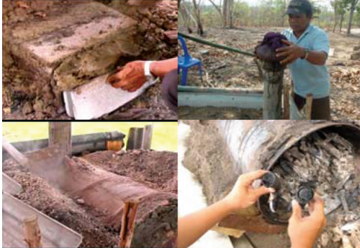
รูปที่ 6 วิธีการดับเตาเมื่อคว้นฟ้าเปลี่ยนเป็นคว้นใส และการตรวจสอบถ่านที่ได้
