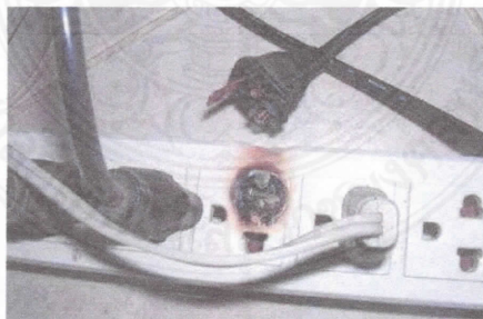
ภาพที่ 3 การไหม้ของอุปกรณ์จากการประกอบและตัววัสดุที่ทนร้อนได้ต่ำ [3]
