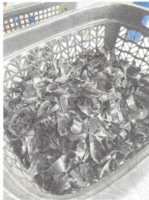
ภาพที่ 21 เศษครีบบางที่เกิดจากการขึ้นรูป
