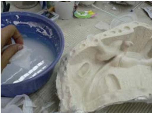
รูปที่ 4 การอัดเป็นรูปร่างโดยใช้กระดาษสาที่มีความละเอียดดีบริเวณผิวของยางซิลิโคน รอให้แห้ง แล้วจึงใช้กาวแบ่งเปียกทาส่วนที่เป็นผิวครั้งแรกเพื่อติดกระดาษสาในชั้นที่สอง ทำซ้ำอีก 2-3 ครั้ง เพื่อให้กระดาษสา มีความหนาประมาณ 1-2 มม. นำไปฝั่งแดดให้แห้ง
