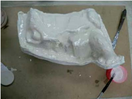
รูปที่ 3 ทำการถอดแบบจากต้นแบบโดยใช้วิธีพิมพ์ขึ้น เนื่องจากหุ่นจำลองมีความซับซ้อนของรูปร่างโดยใช้ยางซิลิโคน
