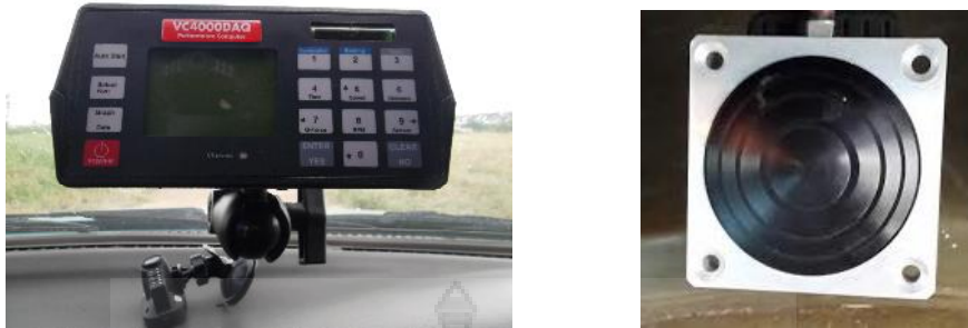
รูปที่ 3.9 การติดตั้งเครื่องมือวัดความหน่วง (ก) เครื่อง VC 4000DAQ (ข) ตัวตรวจจับแรงเหวี่ยงเบรก
