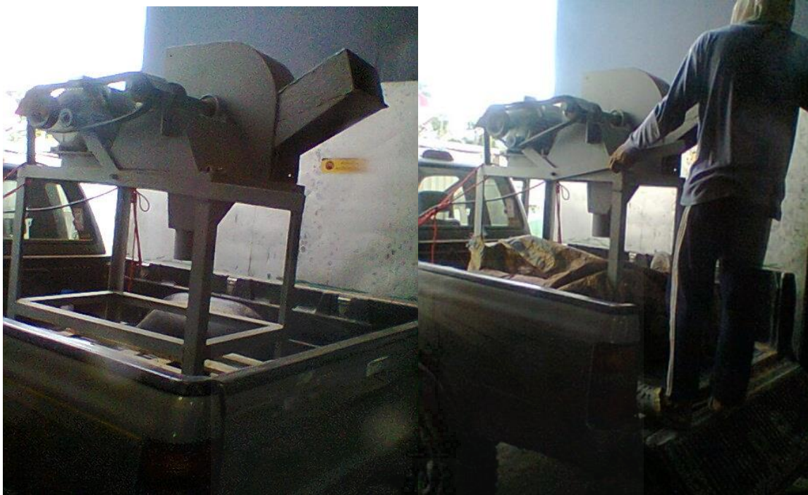
ภาพที่ 9 เครื่องสับย่อยแบบสับชุดไม้ท่อนใช้ทดลองสับย่อยเศษวัสดุจากการเข้างานไม้ มีขนาดมอเตอร์ 5 แรงม้า และผลที่ได้
