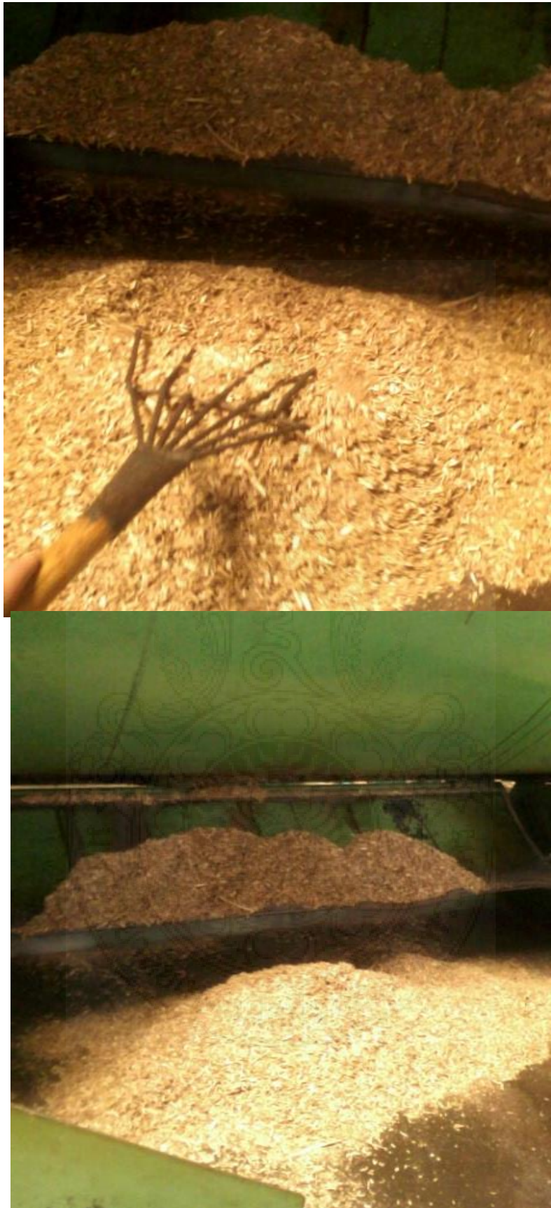
ภาพที่ 17 การผสมกาวตามสูตรที่เตรียมไว้และทำการซั้งน้ำหนักรวมนำไปโรยแผ่นในแบบแม่พิมพ์
