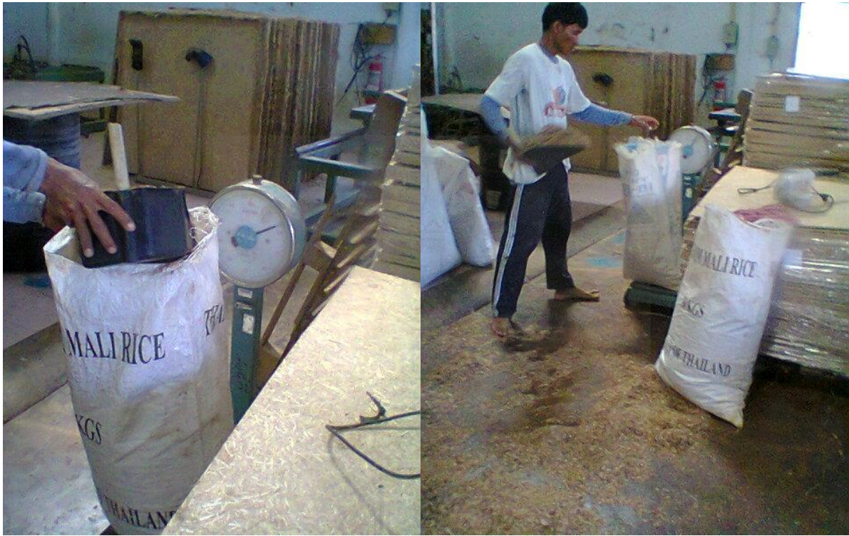
ภาพที่ 15 การชั่งน้ำหนักวัสดุและชั่งน้ำหนักภาวตามสูตรที่เตรียมไว้เตรียมพร้อมในกระบวนการผลิตขั้นต่อไป
