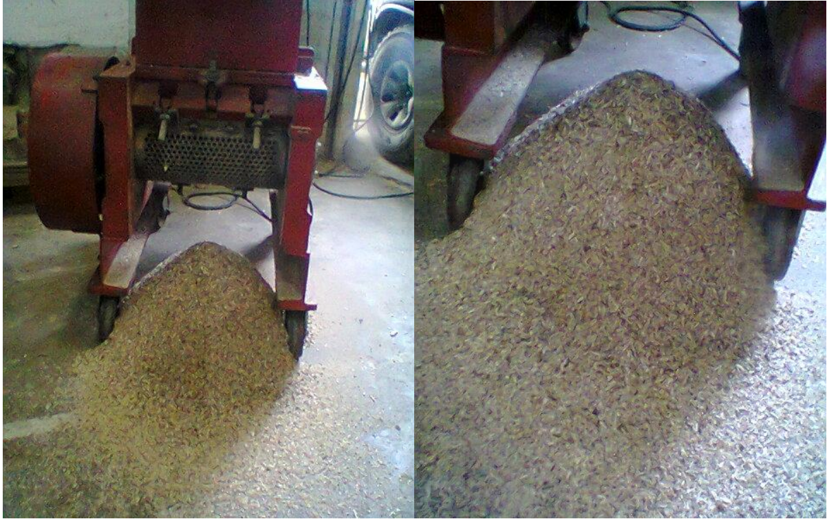
ภาพที่ 11 เครื่องสับแบบเครื่องสับบดย่อยพลาสติกมีขนาดมอเตอร์ 10 แรงม้า และผลที่ได้พร้อมบรรจุ กระสอบนำไปฝังเตตเพื่อลดความชื้นต่อไป
