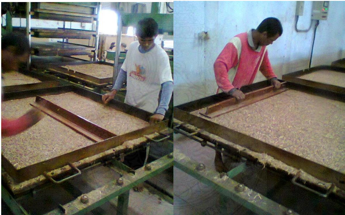
ภาพที่ 20 การนำวัสดุที่ผ่านการผสมกาวและซังน้ำหนักรตามสูตรมาโรยแผ่นในแบบแม่พิมพ์ให้สม่ำเสมอ
