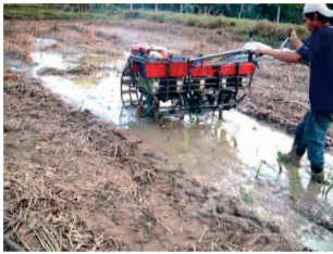
รูปที่ 8 เครื่องปักดำแบบยึดติดกับรถไถนาเดินตาม
