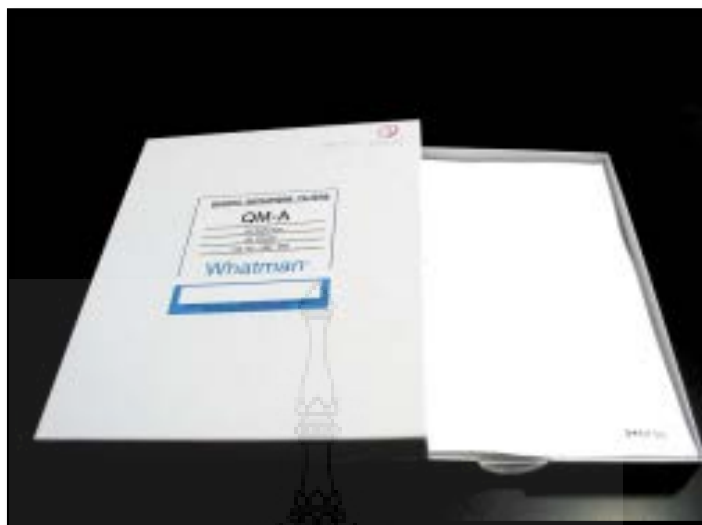
ภาพ 3.10 กระจกกรองใยแก้ว (Quartz fiber filter) ขนาด 8×10 นิ้ว
