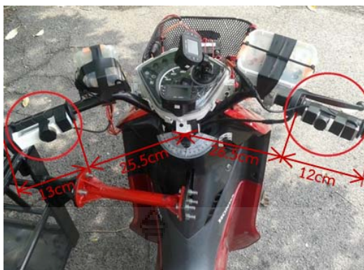
รูปที่ 3.12 การติดตั้งเครื่องมือวัดแรงต้านที่มือซ้ายและมือขวา
