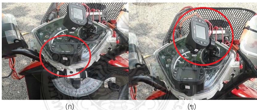
รูปที่ 3.13 การติดตั้งกล่องบันทึกภาพยนตร์ (ก) วัดมุมหักเลี้ยว (ข) วัดความเร็ว
