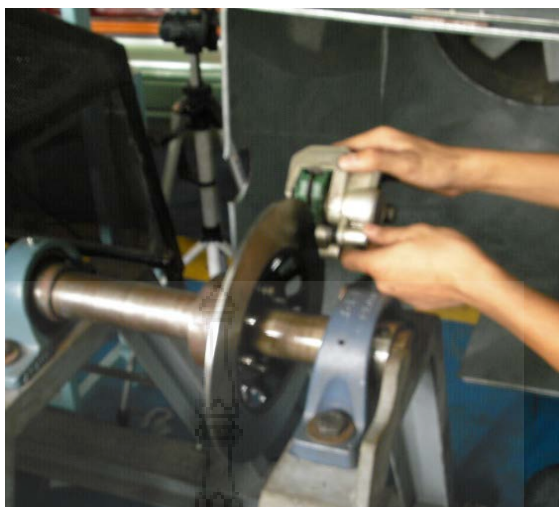
รูปที่ 4.5 การติดตั้งชุดทดสอบ
