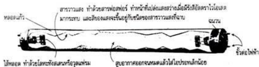
ภาพที่ 70 แสดงส่วนประกอบหลอดฟลูออเรสเซนต์
