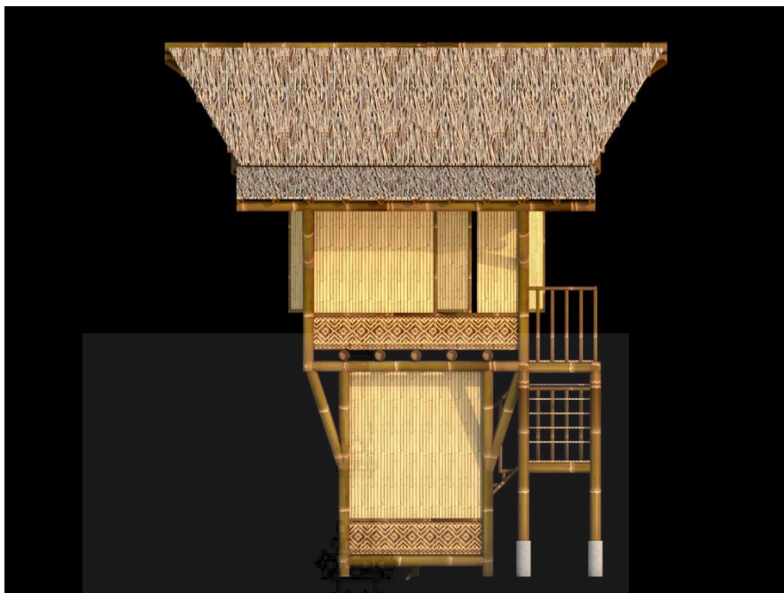
ภาพที่ 3.14 แสดงแบบรูปด้านซ้ายบ้านพักเรือนเครื่องผูกโฮมสเตย์ แบบที่ 3
