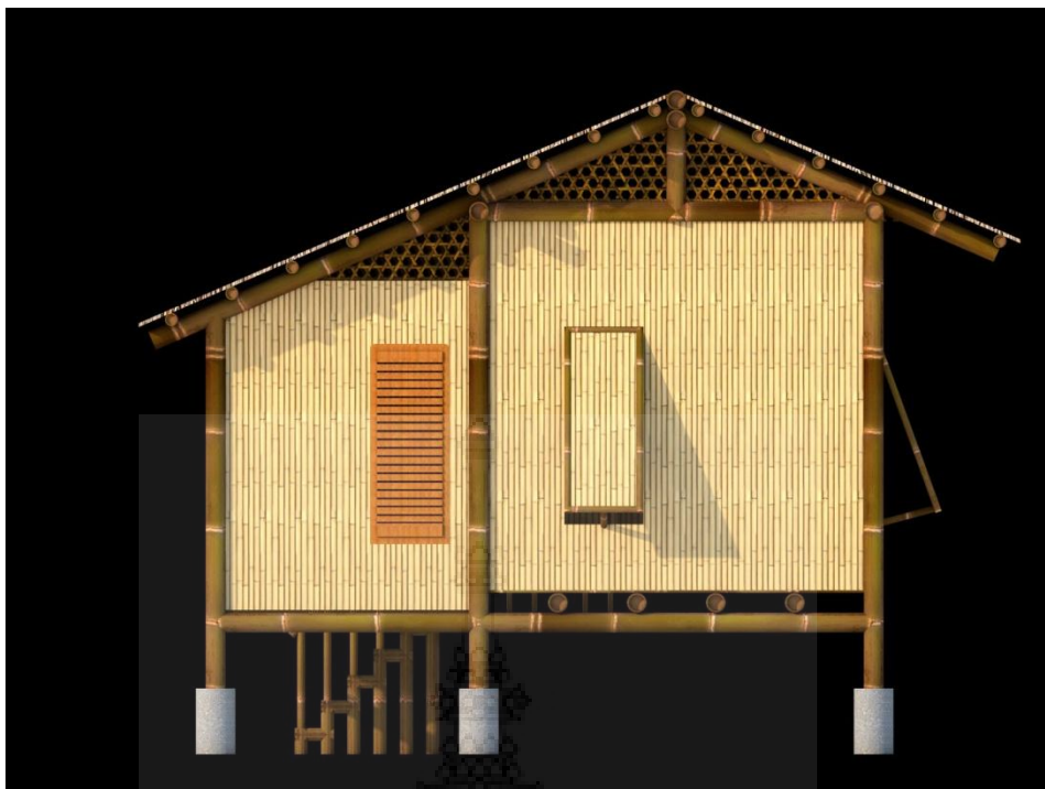
ภาพที่ 3.6 แสดงแบบรูปด้านหลังบ้านพักเรือนเครื่องผูกโฮมสเตย์ แบบที่ 1
