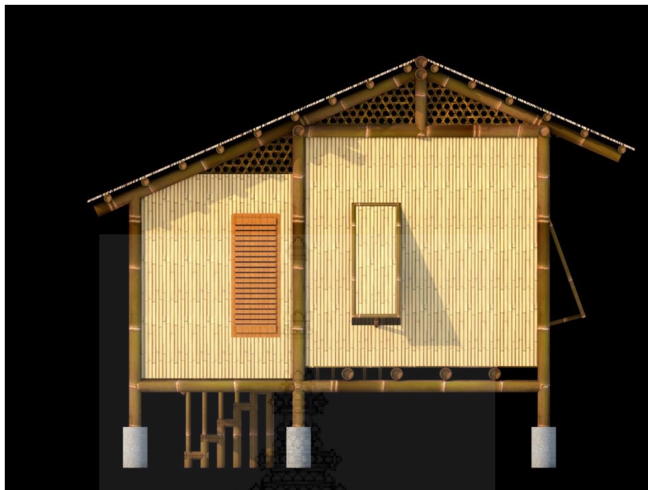
ภาพที่ 4.3 แสดงแบบรูปด้านหน้าบ้านพักเรือนเครื่องผูกโฮมสเตย์ แบบปรับปรุง
