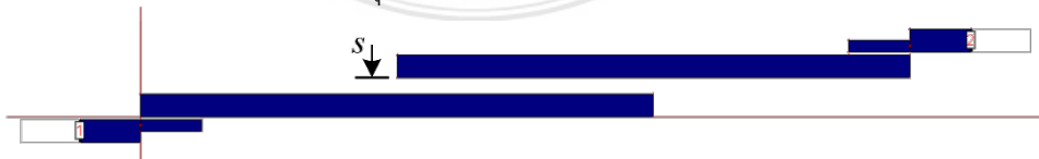
(ก) การจัดวางเรโซเนเตอร์เพื่อหาขนาดสัมประสิทธิ์การเชื่อมโยง
