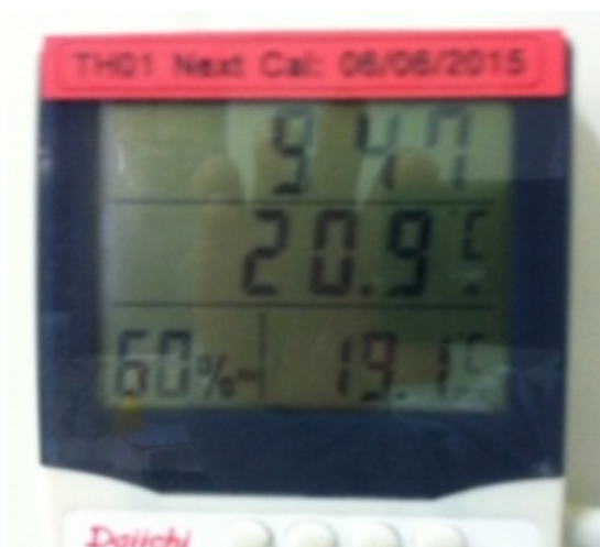
ภาพ 3.15 วัดค่าความชื้นสัมพัทธ์ของห้องปรับอากาศหลังการบำรุงรักษา
