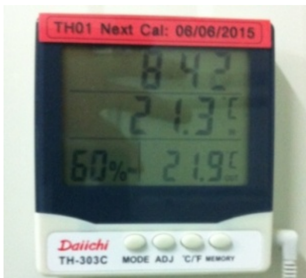
ภาพ 3.5 วัดค่าความชื้นสัมพัทธ์ของห้องปรับอากาศก่อนการบำรุงรักษา
