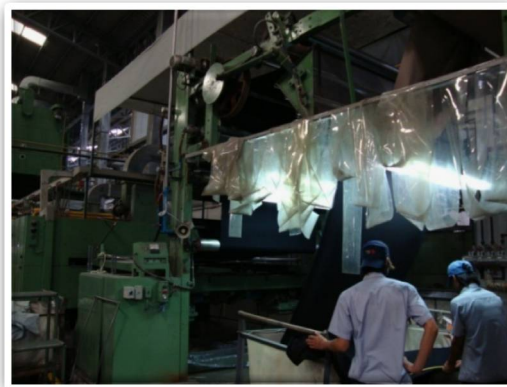
ภาพ 2.23 เครื่อง Brushing ที่มา: บริษัท พัฒนาผ้าไทย จำกัด
