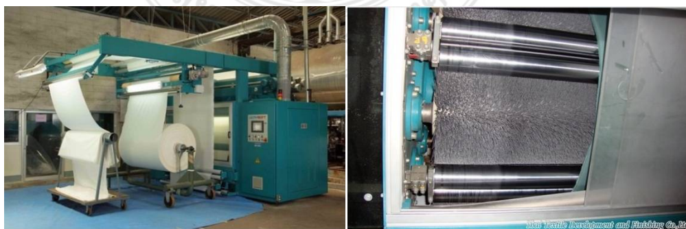
ภาพ 2.22 เครื่อง Brushing ที่มา: บริษัท พัฒนาผ้าไทย จำกัด
