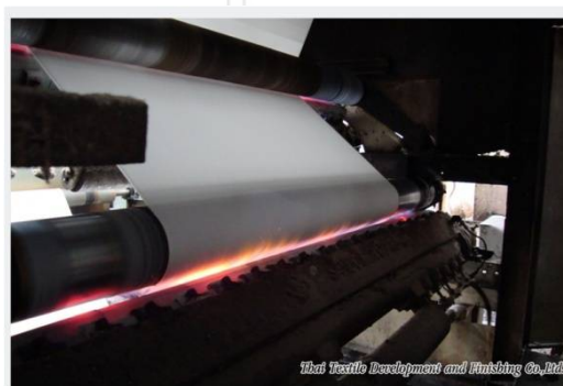
ภาพ 2.9 เครื่อง Gas Singeing ที่มา: บริษัท พัฒนาผ้าไทย จำกัด
