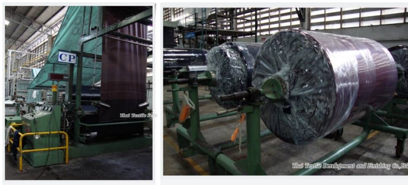
ภาพ 2.18 เครื่อง Cold Pad Batch ที่มา: บริษัท พัฒนาผ้าไทย จำกัด
