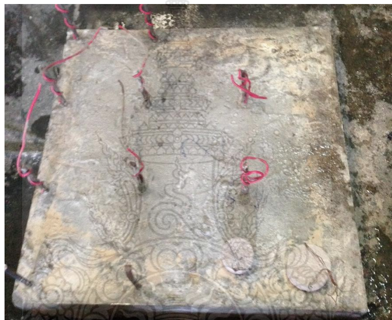
รูปที่ 3-5 แท่งคอนกรีตที่ฝังขั้วเพื่อวัดสัญญาณที่ใช้ในการทดลอง
