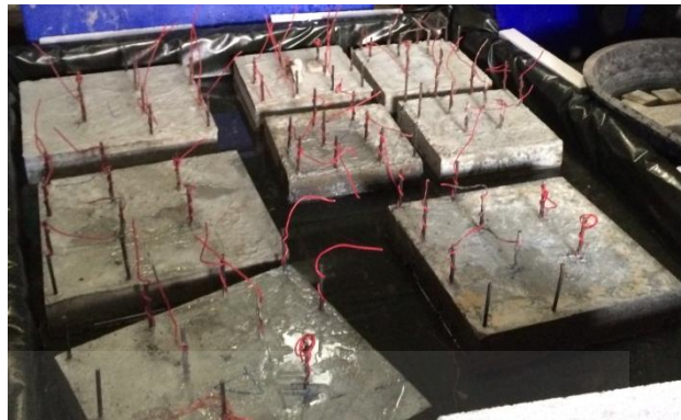
รูปที่ 3-6 การบ่มแท่งคอนกรีตให้เกิดสภาวะการเกิดสนิมเสมือนจริง
