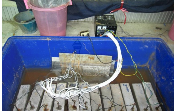
รูปที่ 3-7 การเตรียมตัวอย่างคอนกรีตและการเร่งการเกิดสนิมด้วยกระแสไฟฟ้า
