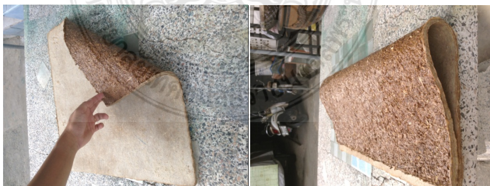
ภาพ ค 7 แผ่นฉนวนกันความร้อนที่แห้งแล้ว ลักษณะยังสามารถงอได้
