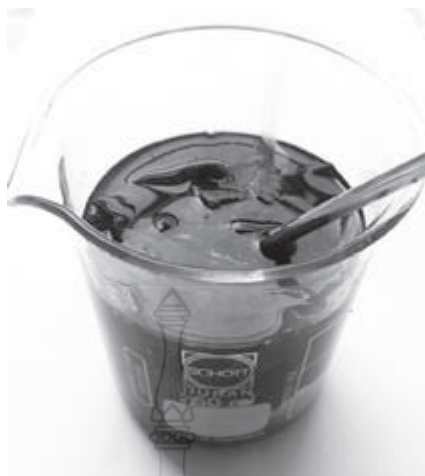
ภาพที่ 2.55 การปั่นกวนยางพาราในสารโซเดียมไฮดรอกไซด์
