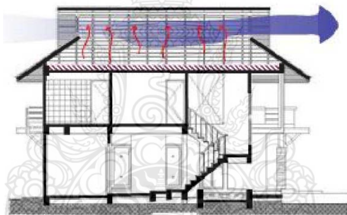
ภาพที่ 2.32 แสดงการติดตั้งฉนวนบนฝ้าเพดาน ความร้อนจะถูกกั้นอยู่ภายในโพรงหลังคา จึงต้องใช้การระบายอากาศภายในหลังคาเพื่อลดความร้อนที่จะสะสมอยู่ภายในที่มาก กรมพัฒนาพลังงานทดแทนและอนุรักษ์พลังงาน กระทรวงพลังงาน เข้าถึงได้จาก (ออนไลน์) http://www.google.com/เอกสารเผยแพร่_แนวทางการเลือกใช้วัสดุก่อสร้างและฉนวนเพื่อการอนุรักษ์พลังงาน
