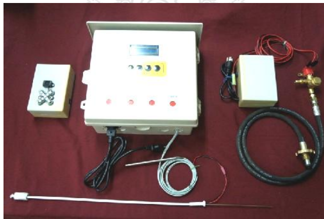
รูปที่ 5 ชุดควบคุมการผลิตสุรากลั่นพื้นบ้านอัตโนมัติด้วยวิธีหล่อเย็น
