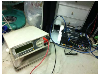
รูปที่ 3-6 การเตรียมอุปกรณ์และเครื่องมือโดยใช้วิธีความต้านทานโพลารไรซ์
