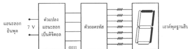
รูปที่ 2-37 อนาล็อกเป็นสัญญาณดิจิทัล ที่มา : Malfaor 2001
