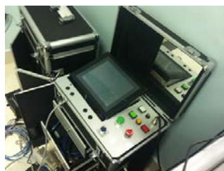
รูปที่ 3-7 การเตรียมอุปกรณ์และเครื่องมือโดยใช้วิธีการส่งคลื่นเพื่อหาความต้านทานโพลารไรซ์
