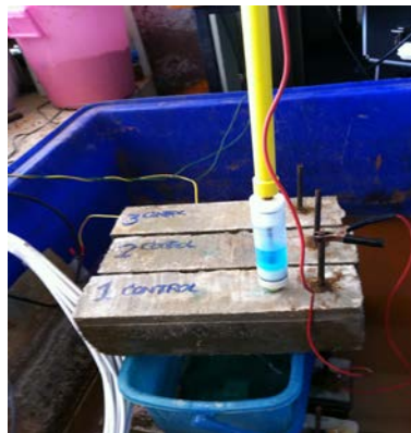
รูปที่ 3-5 การวัดการเกิดสนิมด้วยวิธีความต่างศักย์ไฟฟ้าครึ่งเซลล์
