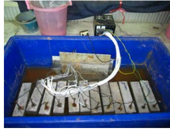
รูปที่ 3-4 การเตรียมตัวอย่างคอนกรีตและการเร่งการเกิดสนิมด้วยกระแสไฟฟ้า
