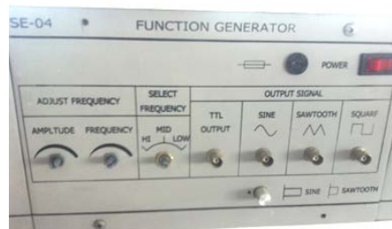
รูปที่ 3-10 การปรับค่าความถี่ควบคุม
