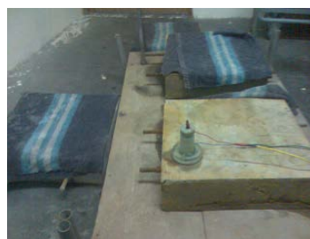
รูปที่ 3-3 การบ่มแท่งคอนกรีตให้เกิดสภาวะการเกิดสนิมเสมือนจริง
