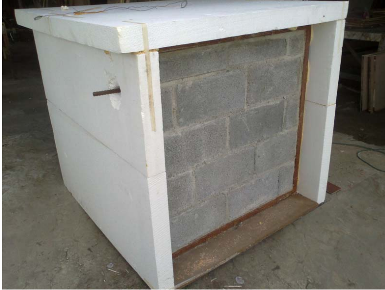
ภาพที่ 4 ถังทดลองคอนกรีตบล็อก
