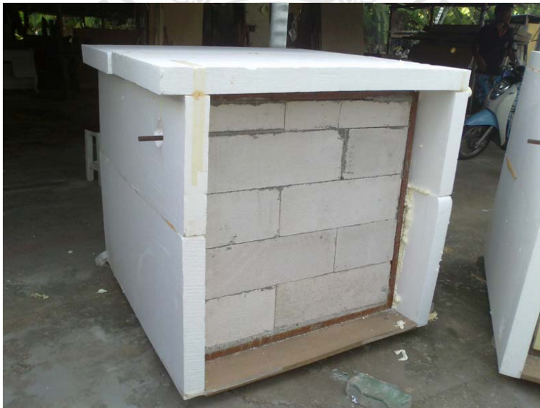
ภาพที่ 5 ถังทดลองคอนกรีตมวลเบา
